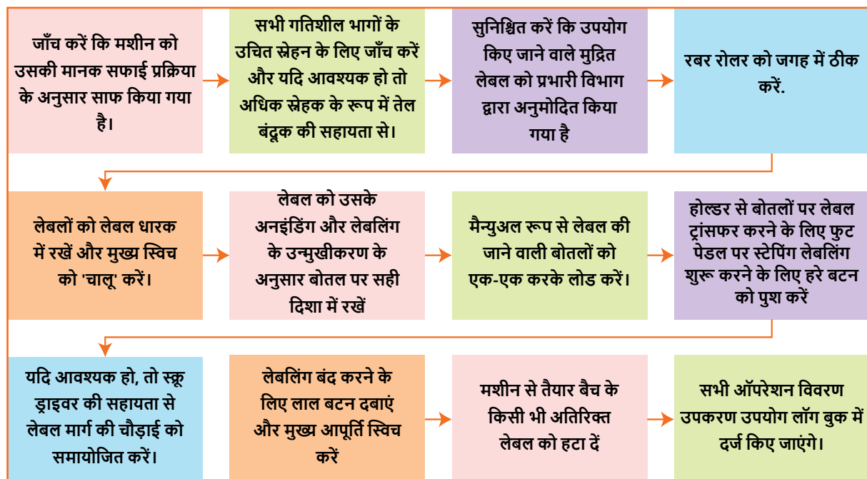
चित्र 5.4.1 लेबलिंग मशीन में लेबल लोड करने की मानक प्रक्रिया।
